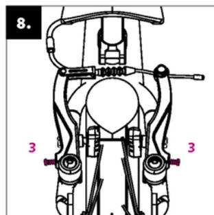
Pokiaľ sa koleso pri otáčaní v niektorom mieste dotýka brzdovej doštičky, upravte symetricky vzdialenosť brzdových ramien napínacími skrutkami (3).
