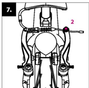
Убедитесь, что между колодками и ободом достаточно места (1-2 мм), если тормозные рычаги на руле не нажаты. Расстояние можно регулировать путем затягивания или ослабления болта (2).
