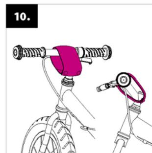
Placera skyddet av tvättbar nylon över styrstängsfästet.
