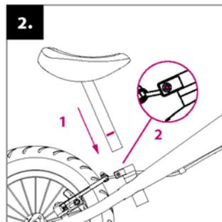
**Montáž sedadla:** vložte sedlovú rúrku do rámu odrážadla (1), nastavte požadovanú výšku sedadla (max. po vyznačenú rysku) a dotiahnite skrutku na objímke (2).
