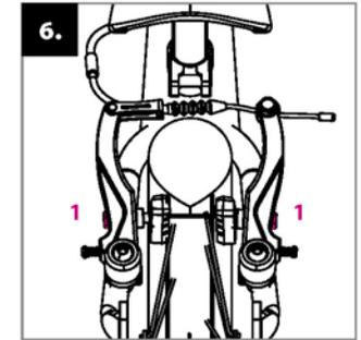
**Afstellen van de remmen:** Druk de beide remarmen van de V-brake in de richting van de velg van het wiel en stel met de juiste sleutel de remblokjes zo af dat ze bij het remmen met hun hele remoppervlak tegen de zijkant van de velg wrijven (1). De remschoen (remblok) hoort de band niet te raken.
