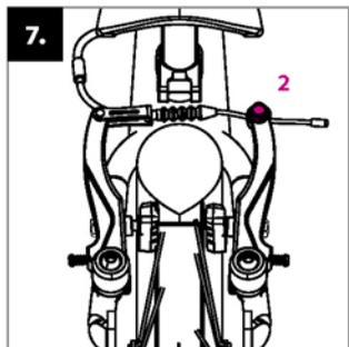
Asegúrese que al soltar el freno, las zapatas se separen lo suficiente de la llanta (1-2 mm). La distancia puede ser corregida ajustando o aflojando el tornillo de anclaje de la palanca de freno (2).
