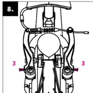
Als het wiel niet vrij kan draaien en "afremt" aan een kant, kan dit bijgesteld worden door het aandraaien van de stelschroef op de arm van de V-brake die het wiel "afremt" (3).
