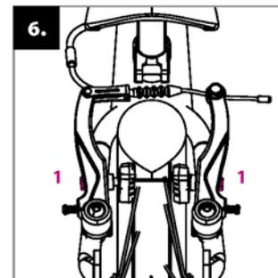
**Fék beállítása:** a fékek beállítása előtt a gumiabroncsokat fújja fel a köpeny oldalán megjelölt értékeknek megfelelően (1,3 és 1,8 bar között ideális)! Ellenőrizze, hogy a fékpókák fékezéskor teljes felületükkel rásimulnak-e a felni oldalára! Helyzetük csavarok segítségével állítható **(1)**. A fékpókák nem érintkezhetnek a
