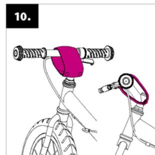
**Installation des protections :** attachez sur la potence du guidon la protection souple en nylon lavable.
