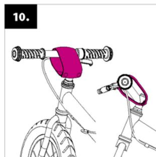
**A védőburkolat felszerelése:** helyezze fel a mosható nylonból készült puha védőburkolatot a kormányszárra!
