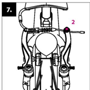
Ellenőrizze, hogy a fékpókák a fékkar kiengedésekor megfelelő távolságba kerülnek-e a felnitől (1-2 mm)! A fékpókák távolsága a fékhuzal meghúzásával vagy kiengedésével állítható a rögzítő csavarban **(2)**.
