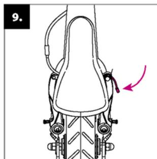
Koniec brzdového lanka zahnite tak, aby neprekážal pri jazde.
