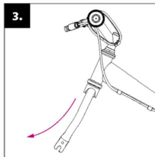
**Vorderradmontage:** Achten Sie darauf, dass die Vorderradgabel richtig positioniert ist und die Biegung der Gabel nach vorne zeigt.
