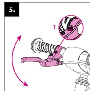
**Seřízení brzdových páček:** nastavte správný sklon brzdových páček pomocí upevňovacího šroubu na objímce (1).
