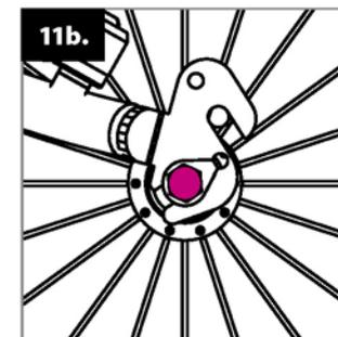
À l'inverse, le crochet inférieur permet de surélever la selle. Attention : vous devez re-régler les freins après chaque modification de la position de la roue arrière.
