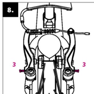
Se la ruota, quando si gira, sbarrata sul ceppo del freno in qualsiasi posto, bisogna sistemare simmetricamente la distanza del braccio del freno usando il tenditore a vite (3).
