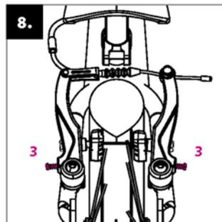
Si en algún momento al girar, la rueda roza la zapata de freno, ajuste simétricamente la distancia del brazo del freno con el tornillo de tensión (3).
