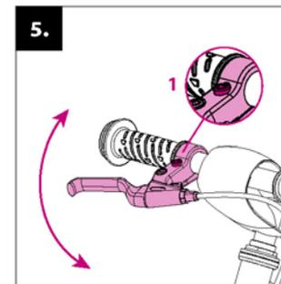
**Регулировка тормозных рычагов:** наклоните тормозные ручки правильно, ослабив болты (1).
