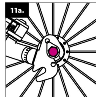
La draisienne Yedoo **TOO TOO ALU** est équipée d'une fourche arrière double permettant d'accroître l'ampleur du réglage de la hauteur de la selle. Le crochet supérieur sert à abaisser la hauteur de la selle.
