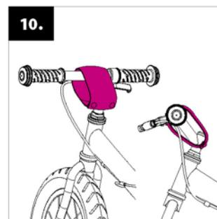
**Lenkerschutz montieren:** Montieren Sie das weiche Schutzband aus waschbarem Nylon mit Hilfe der Klettverschlüsse mittig über die Lenkeraufnahme.
