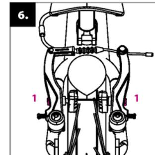
**Ajuste de los frenos:** Antes de ajustar los frenos, infle los neumáticos de acuerdo con los valores en el lateral de la cubierta (idealmente, entre 1,3 y 1,8 bar). Compruebe que al frenar, toda la superficie de las zapatas se apoye en el lado de la llanta. Su posición puede ajustarse con los tornillos (1). Las zapatas no deben tocar la cubierta.
