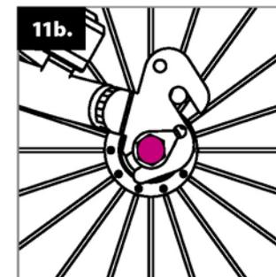
L'attacco inferiore, all'opposto, permette, regolare il sellino in più alto del normale. Attenzione: dopo ogni cambiamento di posizione della ruota posteriore bisogna risistemare i freni!
