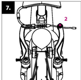
Controleer of de afstand tussen de velg en het remblokje ca 1-2 mm is na het loslaten van de remgrepen. De afstand kan worden aangepast door het aandraaien of losdraaien van de remkabel aan het ankerschroef (2).
