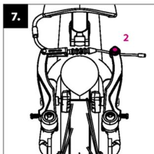
Kontrollera att det är tillräckligt mellanrum mellan beläggen och fälgsidorna (1-2mm) när du släppt bromshandtaget. Avståndet kan justeras genom att skruva åt eller lossa på bromskabeln vid förankringsskruven (2).
