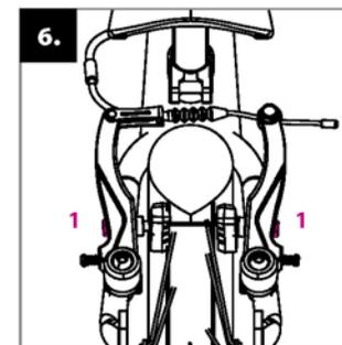
**Seřízení brzd:** před seřízením brzd nahustěte pneumatiky dle hodnot na boku pláště (ideálně mezi 1,3 – 1,8 bary). Zkontrolujte, zda brzdové špalíky při zabrzdění dosedají celou svou plochou na bok ráfku. Jejich polohu můžete upravit pomocí šroubků (1). Špalíky se nesmí dotýkat pláště.
