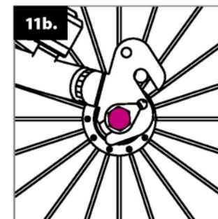
Det lägre hjulfästet gör det möjligt att placera sadeln högre än normalt. Varning: efter man ändrar position måste bromsarna justeras.
