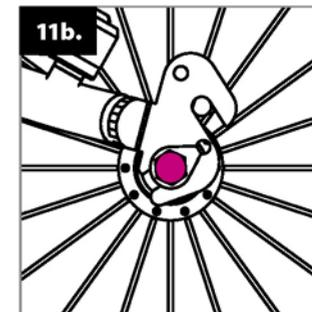
Por el contrario, el gancho inferior permite colocar el asiento a una altura superior a la normal. Precaución: luego de cada cambio de posición, vuelva a ajustar la rueda trasera.
