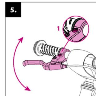
**Nastavenie brzdových páčiek:** nastavte správny sklon brzdových páčiek pomocou upevňovacej skrutky na objímke (1).
