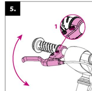
**Ajuste de la palanca de freno:** Ajuste el ángulo correcto de la palanca de freno con el tornillo de fijación en el casquillo (1).
