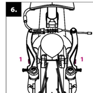
**Justering av bromsen:** före du börjar justera, pumpa upp däckens enligt info på däcksidorna (rekommenderas mellan 1,3 och 1,8 bar). När du bromsar, kontrollera att bromsbeläggen trycks tätt mot fälgsidorna. Positionen kan justeras med hjälp av skruvarna (1). Beläggen ska inte vidröra däckens.
