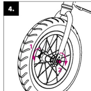
Luego, inserte la rueda en la horquilla, buscando que esté justo en el centro, y ajuste la tuerca (1, 2). (Para facilitar el montaje, puede girar la bicicleta, con las ruedas hacia arriba).
