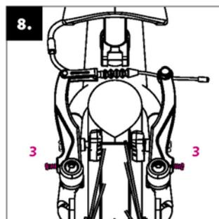
В случае, если тормозные колодки касаются колеса при повороте, отрегулируйте их с помощью затягивания болта (3).
