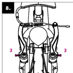
Falls der Reifen beim Drehen an irgendeiner Stelle den Bremsbelag streift, stellen Sie die Entfernung der Bremsarme durch die Spannschrauben (3) symmetrisch ein.
